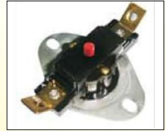
Les bilames à température fixe sont des appareils dont les températures d'étalonnage sont fixées en usine, et qui ne possèdent aucun système de réglage accessible par l'utilisateur. Ils sont utilisés, selon les modèles, comme appareils de régulation ou de sécurité. Les contacts peuvent être à rupture lente ou brusque, de régulation ou à réarmement, à ouverture, fermeture, ou inverseur. Quasiment toutes les options de contact ci-dessus sont réalisables.
