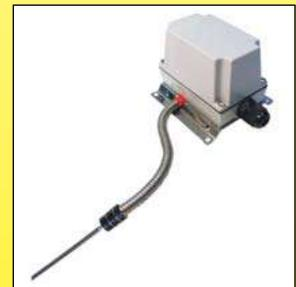
C'est la famille la plus courante pour la mesure et la régulation de température à distance. Les longueurs de capillaire peuvent aller jusqu'à 3 mètres, mais avec une dérive notable due à la quantité de liquide comprise dans le capillaire.
